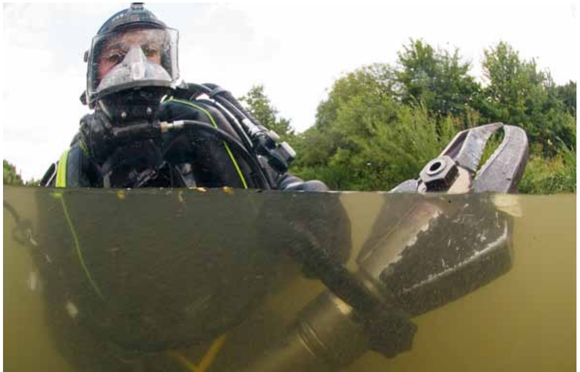
Abb. 1: Feuerwehrttaucher mit hydraulischer Rettungsschere
